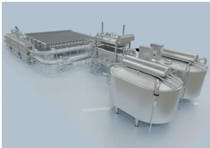
мещения в формах с помощью системы транспортеров направляются для индивидуальной прессовки в прессе. Сыр после окончательного прессования направляется на посолку, а формы после мытья — для повторного использования. Производственная линия может быть дополнительно снабжена автоматической системой сухой посолки зерна.
